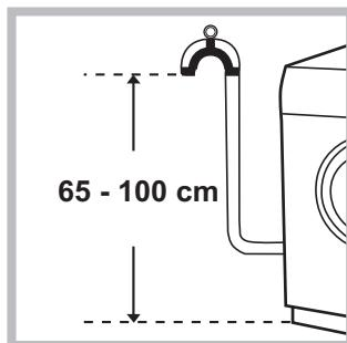
Повесьте запнутый конец сливного шланга на край раковины, ванны, или поместите в специальный вывод канализации. Шланг не должен перегибаться. Верхняя точка сливного шланга должна находиться на высоте 65-100 см от пола. Расположение сливного шланга должно обеспечивать разрыв струи при сливе (конец шланга не должен быть опущен в воду). В случае крепления на край ванной или раковины, шланг вешается с помощью направляющей (входит в комплект поставки), которая крепится к крану (рис.).
